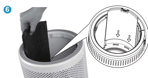
分别将4片炭片放回主机，（将炭片底下的两个卡位对准主机炭片槽的卡位）。
