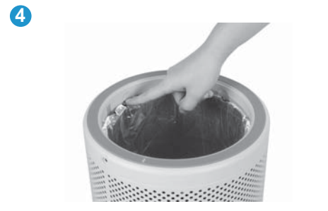
取出炭片，主机内含4片炭片（用手指按住炭片扣位，将扣位压下去后即可轻易取出炭片）。
