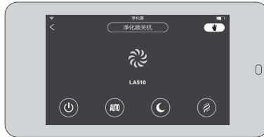
**注意：**在主机为白灯且允许主机触控时，触摸主机触摸环会改变风速，使控制模式进入“手动”，但5分钟后会自动恢复“智能”。如想全手动控制主机风速，可在监控器的手动模式下，或在主机脱离监控器工作时（主机电源/状态灯为绿灯），触摸操作主机。主机将始终保持手动设定，风机不再自动切换回“智能”模式。不建议让主机工作在“手动”模式，因为会造成不必要的能源浪费和额外的滤芯损耗。
