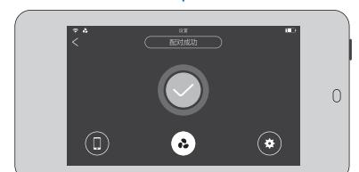
3、在监控器上点击 设置 → → 配对，监控器即和主机进入自动配对流程。
