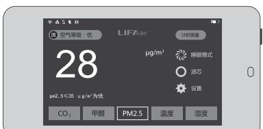
注意：监控器屏幕左上方的背后是PM2.5 传感器的进气口，如需测量气流中的 PM2.5 浓度，应使此口对准且迎向气流方向。
