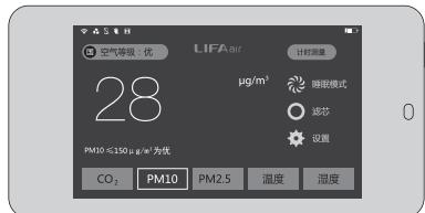
点击 “PM2.5” 显示 PM2.5 的实时测量值。数值的稳定大约需要20秒。中国标准75 $\mu\text{g}/\text{m}^3$  以下为良；美国标准为35 $\mu\text{g}/\text{m}^3$  以下。
