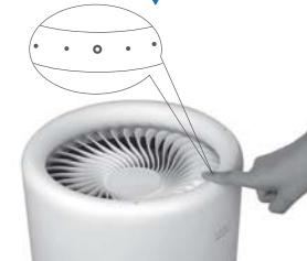
2、逆时针滑动触摸环使主机绿灯缓慢闪烁，单指长按触摸环上标记“●”五秒以上，直至绿灯快速连续闪烁后移开手指，此时主机进入为时30秒的配对模式。
