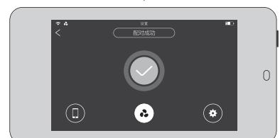
3、在监控器上点击设置 → ● → ●，监控器即和主机进入自动配对流程。
