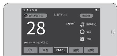
注意：在监控器与主机配对工作时（主机白灯指示），即使屏幕只显示时钟（插上电源）或黑屏（电池供电），监控器会自动定时监测空气质量，并且控制主机运行。
