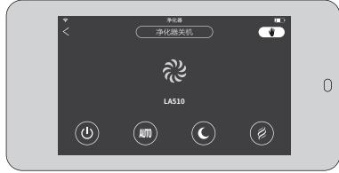
注意：在主机为白灯且允许主机触控时，触摸主机触摸环会改变风速，使控制模式进入“手动”，但5分钟后会自动恢复“智能”。如想全手动控制主机风速，可在监控器的
