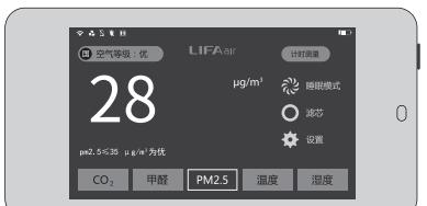
注意：监控器屏幕左上方的背后是PM2.5 传感器的进气口，如需测量气流中的 PM2.5 浓度，应使此口对准且迎向气流方向。
