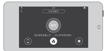
注：主机与监控器配对时必须将主机调至待机状态（即绿灯缓慢闪烁状态）。
