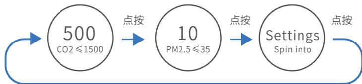
(1.1) 在CO<sub>2</sub>和PM<sub>2.5</sub>画面下，快旋进入风速显示页面，显示当前风机转速级别（“0”为不转，“32”为最高），然后再旋转可调节风速大小，若10秒后无操作则返回主菜单。
