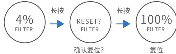
(2.5) 在Reset?（复位）模式下，长按 显示屏即可恢复出厂设置，屏幕显示“Reset OK”（“复位成功”），3秒后将自动返回至主菜单。
