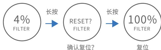
在FILTER模式下，长按显示屏，屏幕显示“RESET?”此时再长按显示屏，即可对滤芯剩余百分比进行复位。
